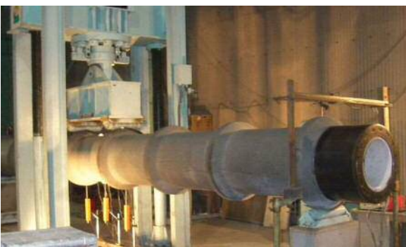
曲げ試験状況写真
